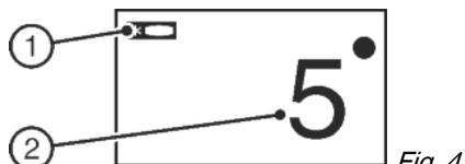
Fig. 4 (1) Symbol Chladnička (2) Ukazatel teploty v chladničce
